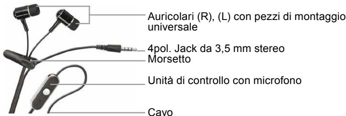
Fig.4: Elementi di comando e parti
